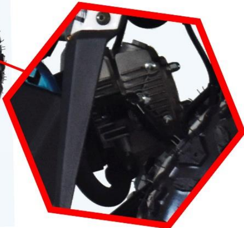
Одноцилиндровый, 4-х тактный 125 см 3
