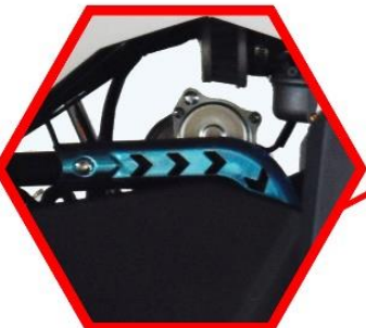
Стальная выхлопная труба с защитой
