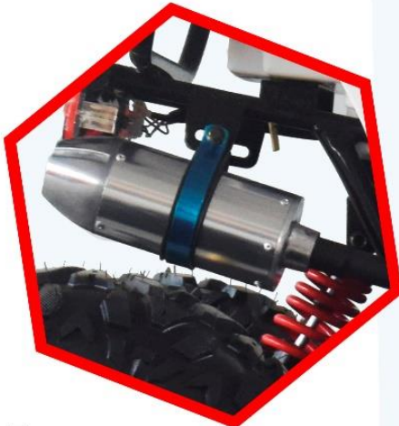
Глушитель из нержавеющей СТАЛИ С ДЕМПФЕРНЫМ КРЕПЛЕНИЕМ
