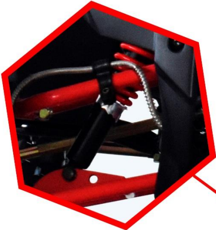
АМОРТИЗАТОРЫ С РЕГУЛИРОВКОЙ ЖЕСТКОСТИ
